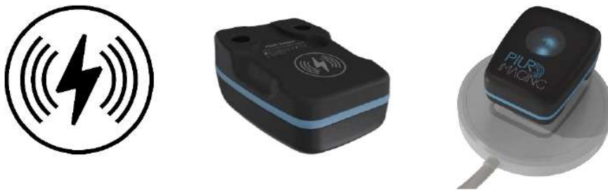
Figura 21: Sensor PIUR en una base de carga
