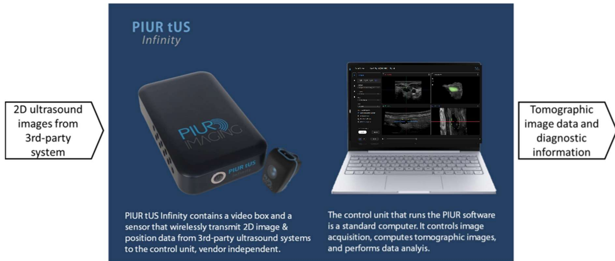
Figura 1: Configuración del sistema PIUR tUS Infinity
