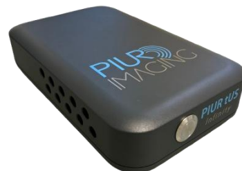
Boîte Infinity RÉF 1000 (Entrée HDMI pour câble vidéo à connecter à un appareil à ultrasons)
