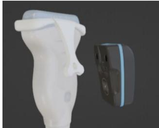
2. Rimuovere con cura tutti i residui e la sporcizia dall'alloggiamento del sensore utilizzando, se necessario, un panno morbido e umido.
